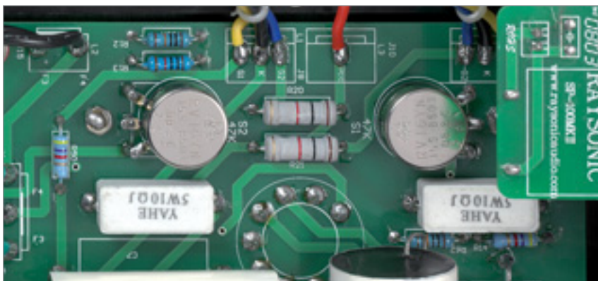
Eher unexotisch: Zwei Potentiometer dienen zur Einstellung der Gittervorspannung der Endröhren, regeln damit also den Ruhestrom
