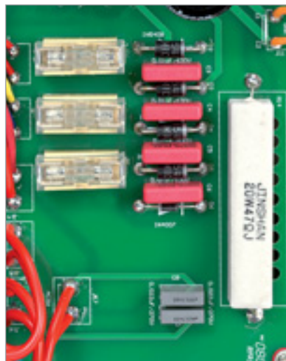
Nummer sicher: Im Netzteil stecken zusätzliche Feinsicherungen
